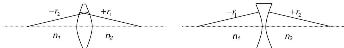
in Luft mit  $n_{\text{Luft}} = 1$  gilt daher:  $D = \frac{1}{f} = \frac{1}{g} + \frac{1}{b}$       $\Rightarrow \frac{1}{f} = (n_{\text{Linse}} - 1) \left( \frac{1}{r_1} - \frac{1}{r_2} \right)$
