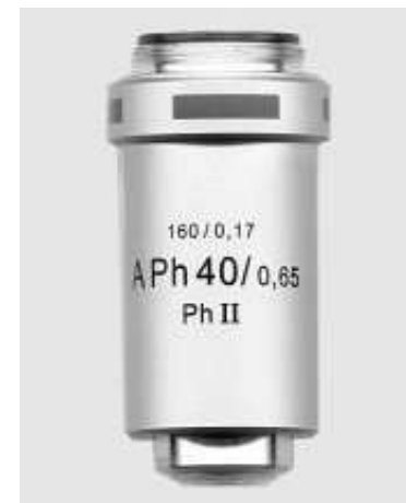
Abbildung 11: Kommerzielles Objektiv eines Lichtmikroskops. Die Objektivvergrößerung beträgt 40. Die Zahl 160 besagt, dass das Objektiv nur für Mikroskope mit einer Tubuslänge von 160 mm verwendet werden kann. Zusätzlich ist noch die numerische Apertur, NA=0,65 und die zu verwendene Deckglasdicke von 0,17 mm angegeben.
