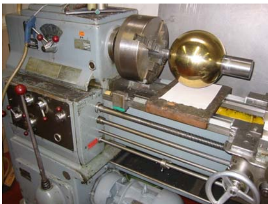
Abb. 3.8.: polierte Pendelkugel auf Drehbank
